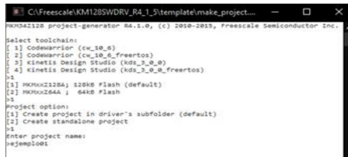
FIGURA 4.3 CREACIÓN DEL PROYECTO CON “MAKE\_PROJECT”.
