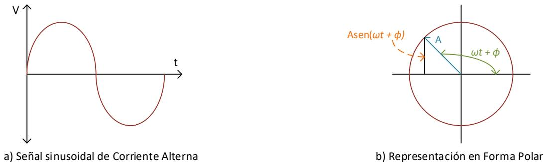
FIGURA 2.1 REPRESENTACIÓN DE ONDA SINUSOIDAL EN COORDENADAS POLARES.
