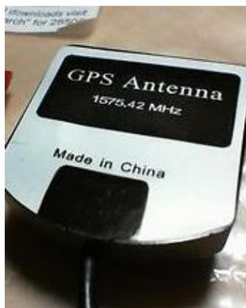
FIGURA 3.21 ANTENA EXTERNA DEL MÓDULO GPS.
